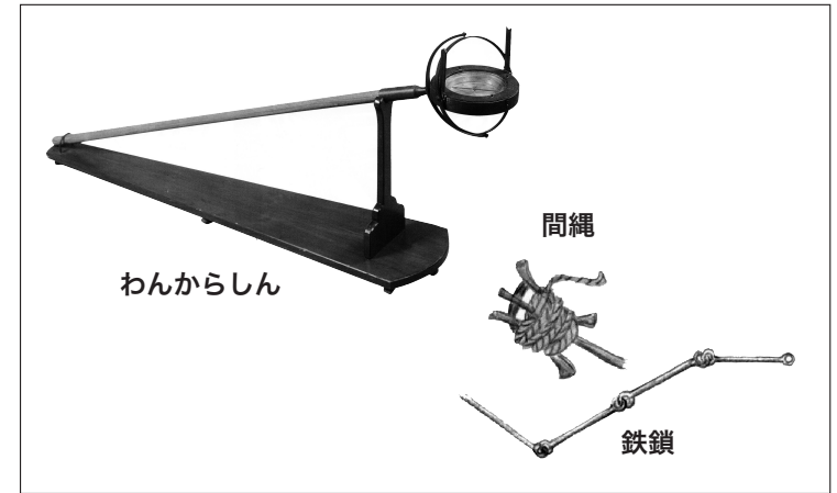
図 2-23 伊能忠敬が使用した測量機器
