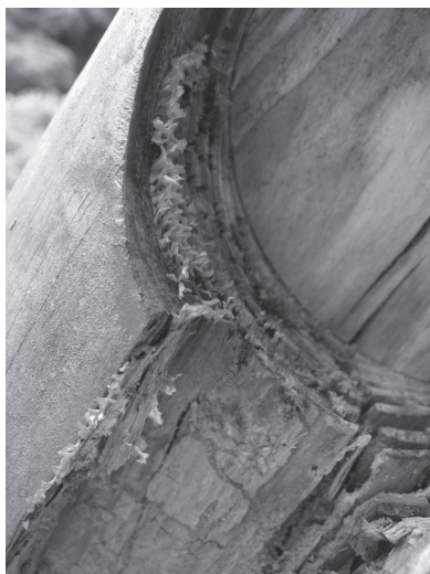
図3.1 | 公園の柵に発生したアカキクラゲの子実体(キノコ)。木材は褐色腐朽を受けている。沖縄にて(口絵3)。
