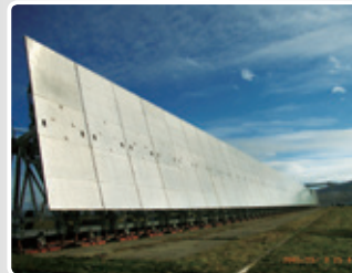
太陽観測用の副鏡。太陽光の収束を避けるため平面鏡が用いられている。位置は固定されているが、角度は変えられる。撮影：2005年11月3日、筆者による。
