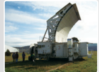
天体観測用の副鏡。レール上におかれ、移動できる。副鏡で反射した電波は下の観測小屋内の受信機に集光する。撮影：2005年11月3日、筆者による。
